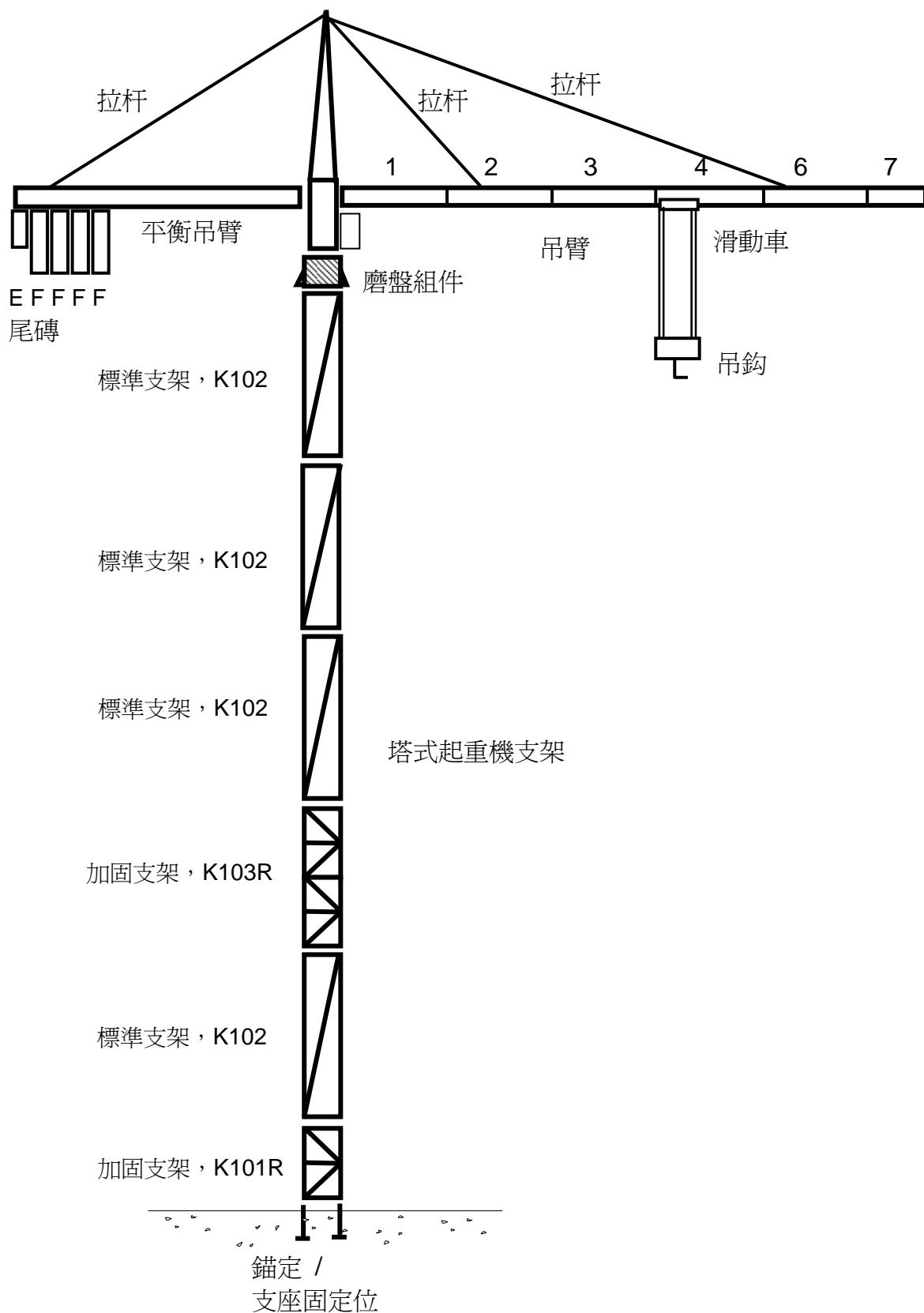
本人已核實下述構成塔式起重機的主要部件（重要配件）符合生產商的規格：
