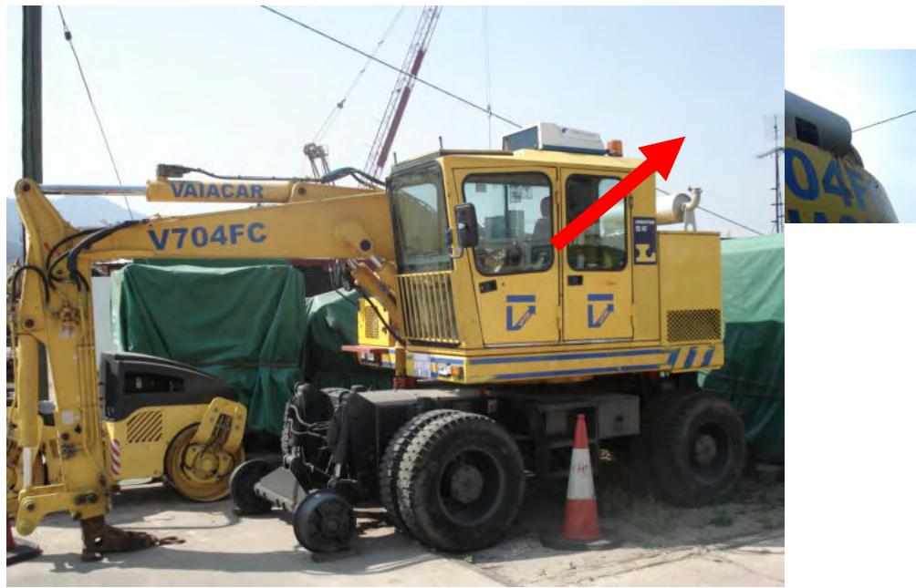
圖 4：安裝 1 部攝影機的挖土機設置
