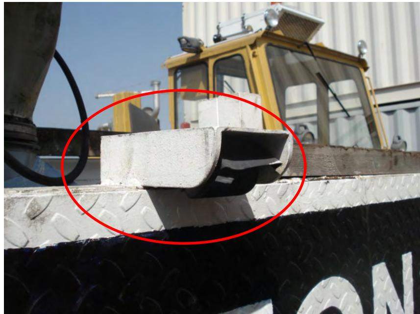
圖 5：攝影機的安裝托架
