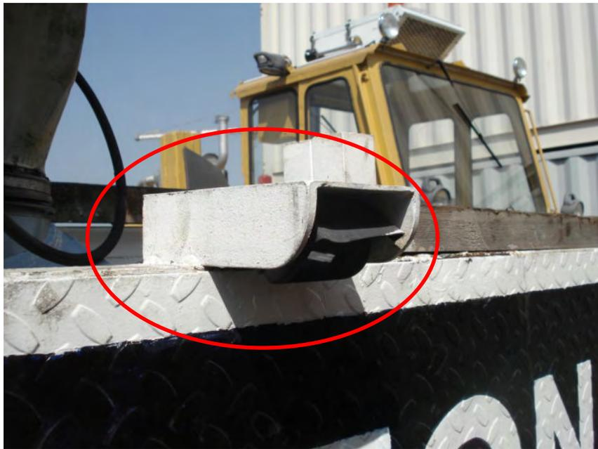
圖 5：攝影機的安裝托架
