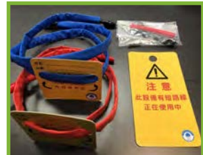
圖 2 (8.1.1c.iii): 臨時短路線
