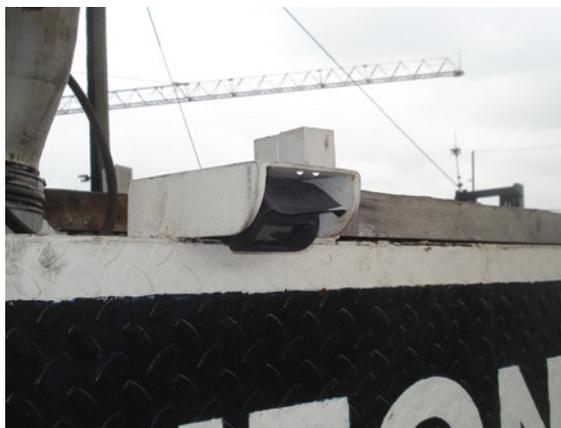
圖5：攝影機的安裝托架
