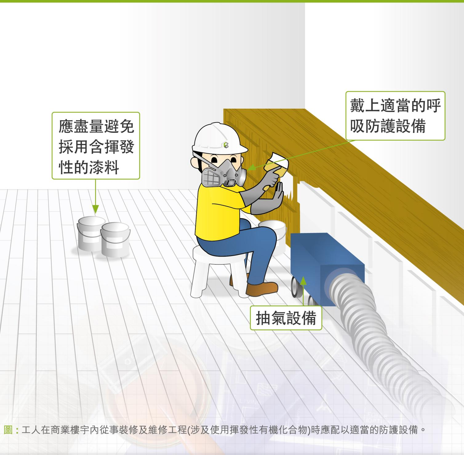
圖：工人在商業樓宇內從事裝修及維修工程(涉及使用揮發性有機化合物)時應配以適當的防護設備。
