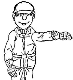
9. 吊運期間時常運用手號溝通，圖中手號表達為準備驅動機械。
