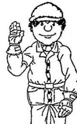
11. 吊運期間時常運用手號溝通，圖中手號表達為短距離慢駛。
