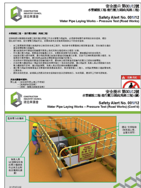
安全提示第 001/12 號水管鋪設工程 – 進行壓力測試 ( 馬路工程 )
