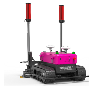
地面抹平機械人
