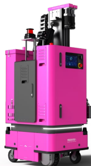
牆面打磨機械人
