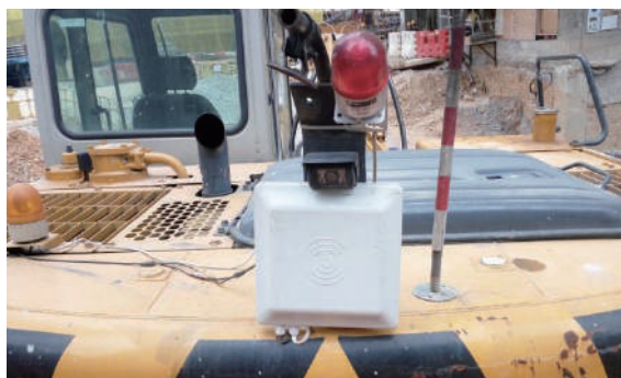
移動設備操作區域的不安全行為/危險情況警報
