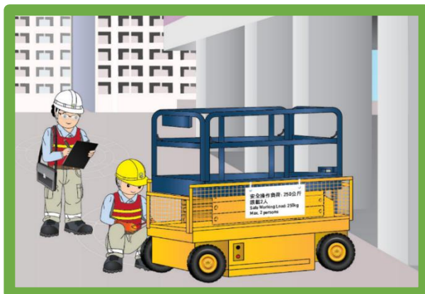
根據製造商的手冊，定期檢查、測試和妥善維修升降台及其重要部件
