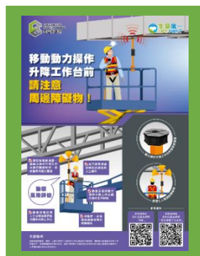
海報 - 移動動力操作升降工作 台前，請注意周邊障礙物！
