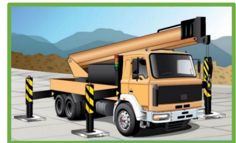
貨車式起重機設置地點需為穩固的地面並能足夠承托起重機及負荷物的重量
