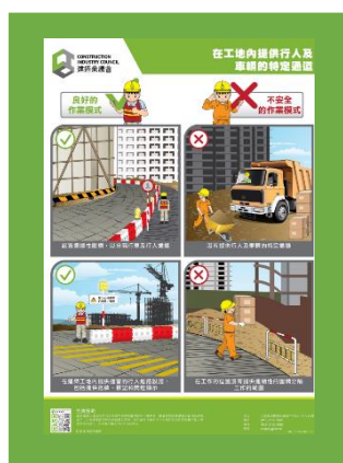
海報 - 在工地內提供行人及車輛的特定通道
