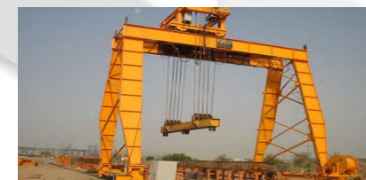
龍門架起重機 (GANTRY CRANE) (龍門式起重機)
