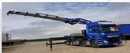
貨車式起重機 (TRUCK-MOUNTED CRANE)
