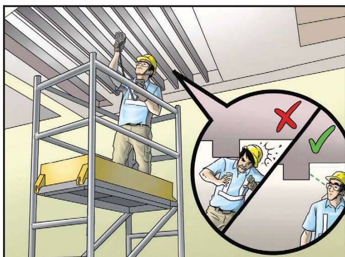
在使用工作平台前和正在使用平台時，工人應留意頭頂上的空間並查看有否障礙物，以防止意外地撞擊頭部。應配戴附有下頷帶的安全帽
