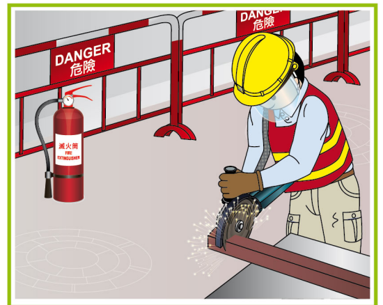
提供滅火設備
