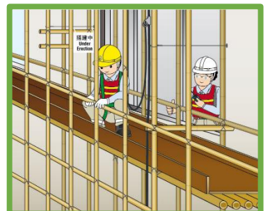
工人配戴全身式安全吊帶，並把懸掛繩繫於穩固點的繫穩裝置（例如：羊眼圈）或連接到獨立救生繩上的防墮裝置
